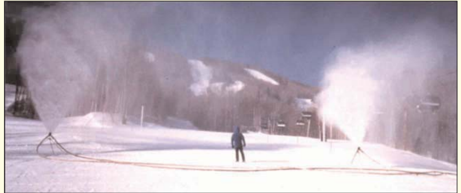
Zwei Lanzen mit den gleichen Schnei-Bedingungen - einmal ohne (links) und einmal mit SNOMAX
