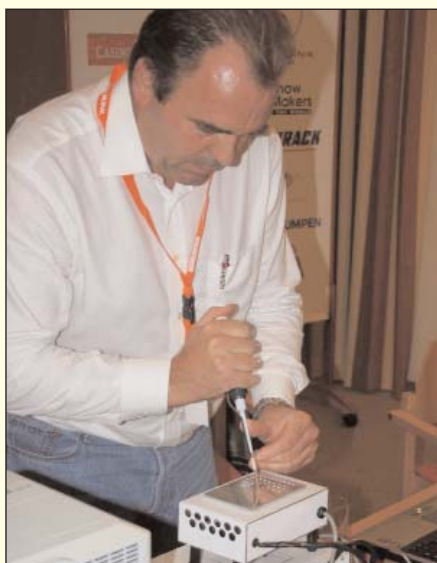
Marco Bieri: Bei den Tropfen auf der Kälteplatte, wo die Temperatur exakt Grad für Grad gesenkt werden konnte, zeigt sich deutlich, dass das mit SNOMAX versetzte Wasser erheblich früher zu Eis wird – so deutlich, dass man bei der Beobachtung fast vermeinte, das entsprechende „Klack“ direkt hören zu können.
