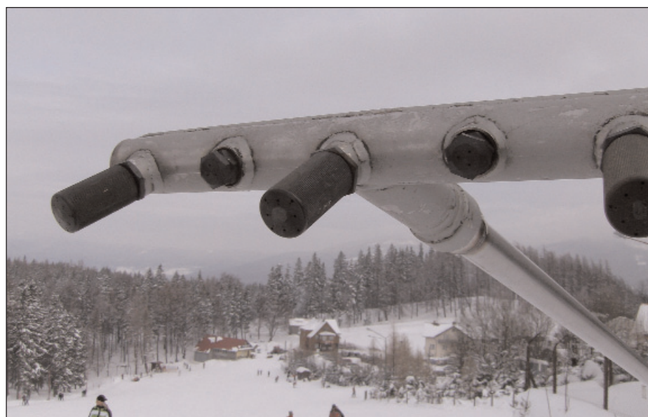
Alte Technik neu adaptiert: Schnei-Lanzen aus polnischer Produktion
