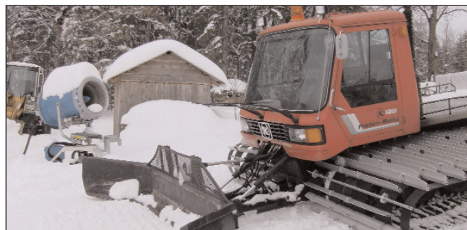
Der "bessere" Schnee durch Snomax ® -Einsatz ermöglicht auch eine bessere Pistenpräparierung mit den älteren und schwächeren Maschinen
