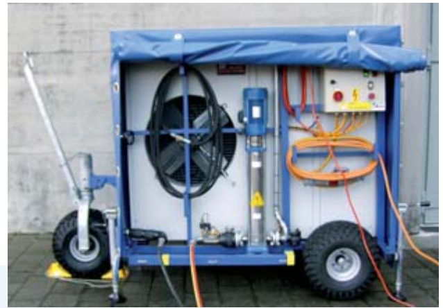
Die von SMI konzipierte mobile In-/Outdoor-Beschneigungs-Anlage für die SBB.
