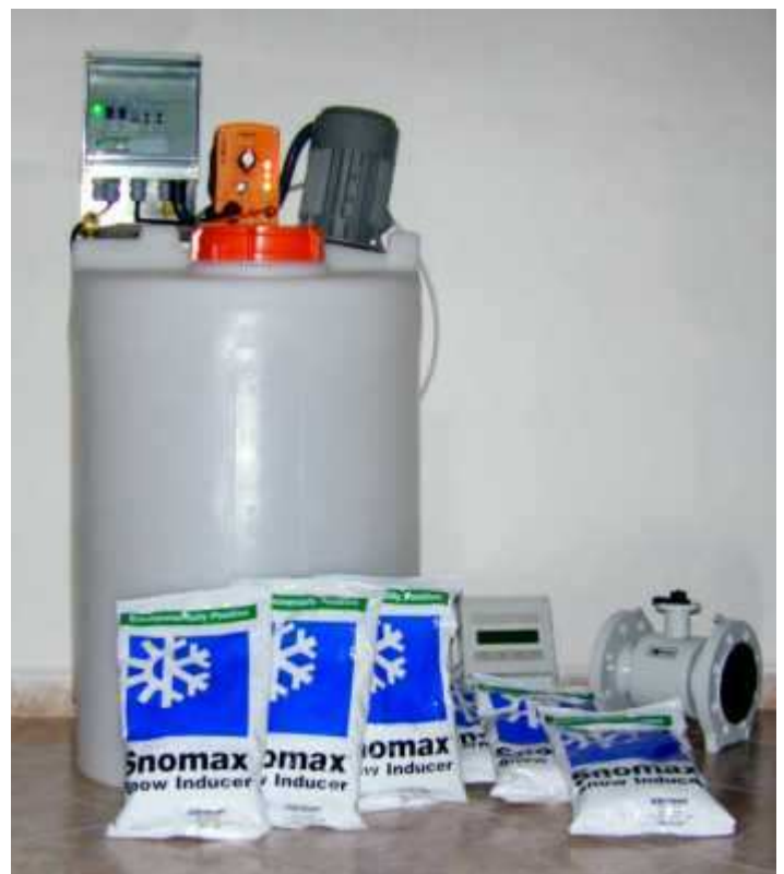
Dávkovací zařízení Snomax s indukčním průtokoměrem
